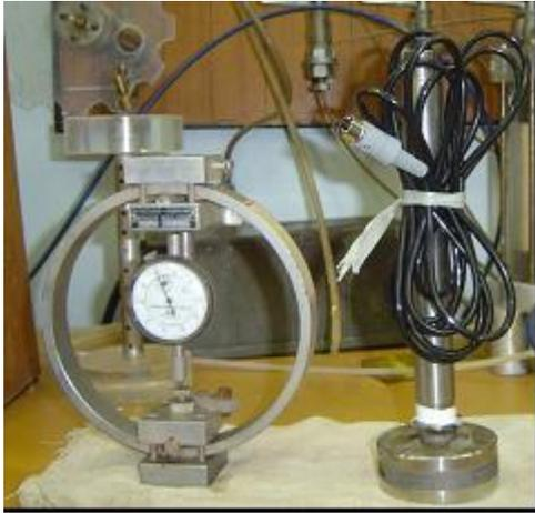
Figura 47 – Anel de carga e célula de carga
