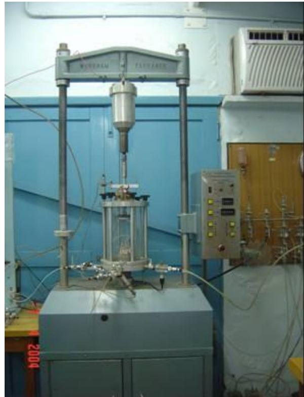
Figura 41 - Célula e prensa Triaxial(PUC-Rio).
