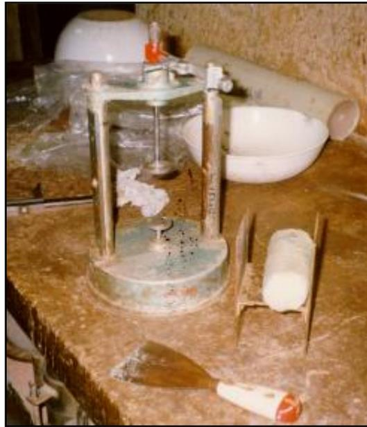
Figura 61 - Moldagem do Corpo-de-Prova
