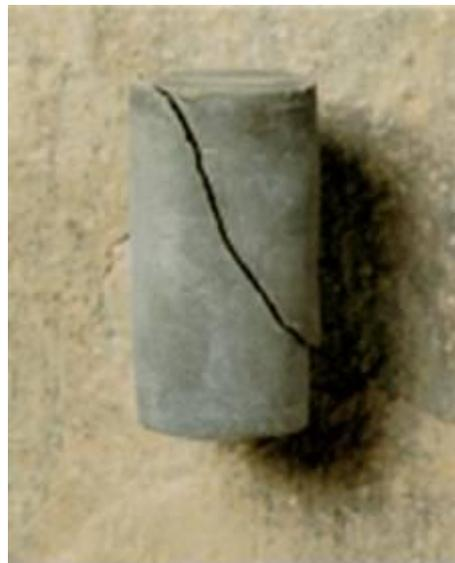
Figura 52 – Corpo de prova ao final de ensaio
