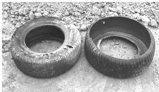
Fig. 4 - Configuração dos pneus: inteiros x cortados.
