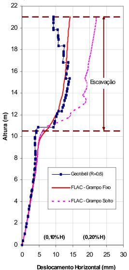
Figura 5: Distribuição de deslocamento horizontal (PLAXIS x FLAC).
