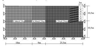
Figura 3: Discretização da malha (FLAC).
