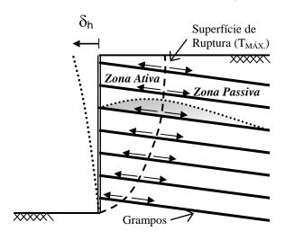
Figura 1: Definição da superfície de ruptura a partir das zonas ativa e passiva de escavações grampeadas.
