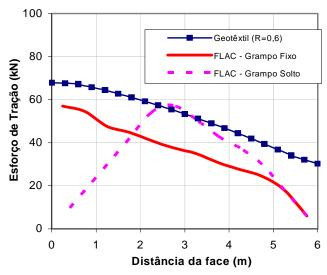
Figura 6: Distribuição de esforços ao longo do grampo 5 (PLAXIS x FLAC).
