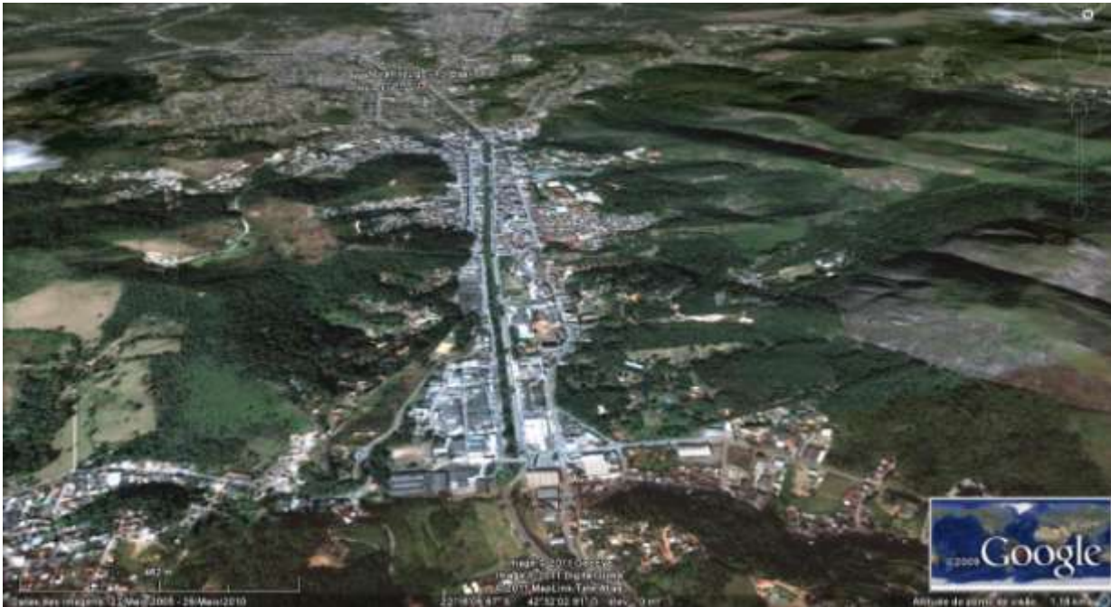
Figura 81: Cidade de Nova Friburgo. Imagem Google Earth de 2010. Pode-se observar a canalização do rio em toda a extensão da cidade. Mesmo rios canalizados exigem a manutenção das faixas marginais de APP. No caso em tela 30 metros em cada margem não deveriam estar ocupados.
