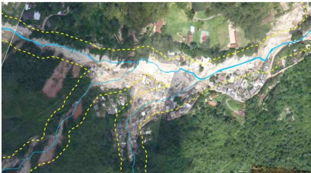
Figura 30: Vista aérea da vila do Bairro Campo Grande após a tragédia, mostrando os efeitos da inundação e corrida de lama e rochas sobre as casas e outras edificações ao longo do rio. Nota-se claramente que as áreas mais afetadas são aquelas situadas dentro da faixa de APP (delimitadas pela linha pontilhada amarela). Foto de 24.01.2011
