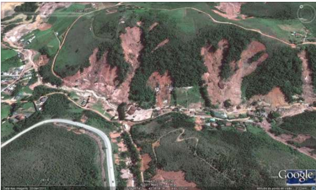
Figura 65: Imagem Google Earth de 20.01.2011 da mesma região mostrando deslizamentos e corrida de lama e rochas que atingiram casas na encosta e na margem dos cursos d'água. Notam-se os topos de morros desmatados e intervenções diversas nas encostas: construção de estradas e edificações. Nota-se também que as casas e outras edificações nas margens dos cursos d'água foram severamente afetadas.
