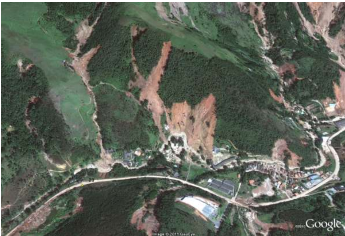
Figura 69: Imagem Google Earth 19.01.2011. Mesma região do Córrego Dantas às margens da rodovia BR 492. Nova Friburgo. As edificações nas margens dos cursos d'água (principal e afluentes) foram severamente afetadas. Observa-se também topos de morros desmatados e construção de estradas no sopé do morro e na meia encosta, em área com declividade acima de 45°.
