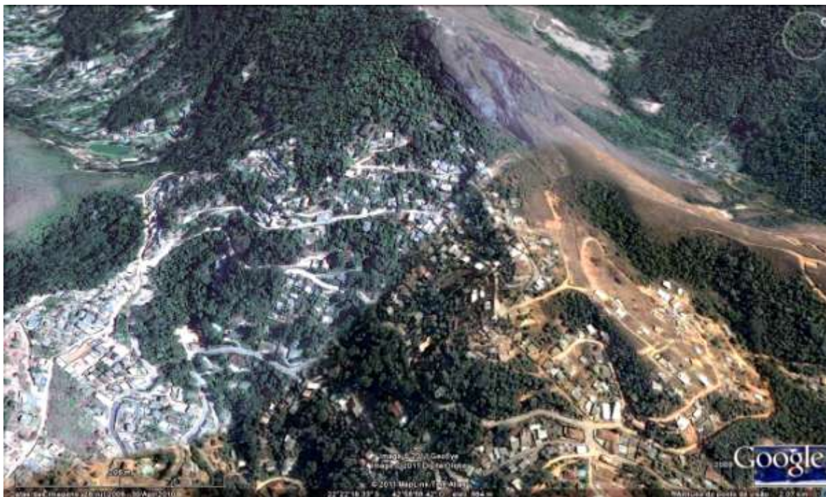
Figura 42: Bairro Granja Florestal, Teresópolis. Imagem Google Earth de 2006/2010. Imagem mostra ocupação de área de alta declividade (~entre 30 e 70°). Nota-se uma série de arruamentos construídos em curva de nível, bem como ligações entre estes arruamentos. Há também cortes (terraplanagem) no morro para construção das edificações.
