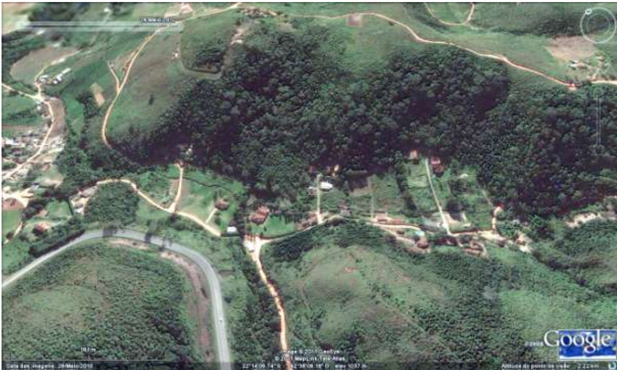
Figura 64: Vista de região com parcelamento do solo com construções na meia encosta de morro com inclinação superior a 45^\circ e com topo do morro desmatado. Observa-se construções também na margem dos cursos d'água. BR 492 em Nova Friburgo. (Google Earth de 26.05.2010).
