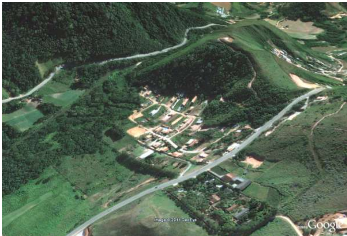
Figura 74: Imagem Google Earth 25.05.2010. Condomínio do Lago, BR 492. Nova Friburgo. Observa-se que o condomínio foi instalado numa área plana com habitações construídas junto a base de morro com topo desmatado e estrada cortando seu vértice.
