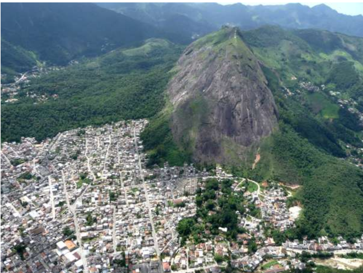
Figura 8: Nova Friburgo. Foto aérea (26.1.2011). A foto mostra topo de morro com afloramento do granito e ocupação de parte da área próxima ao sopé da montanha, considerada área de risco.
