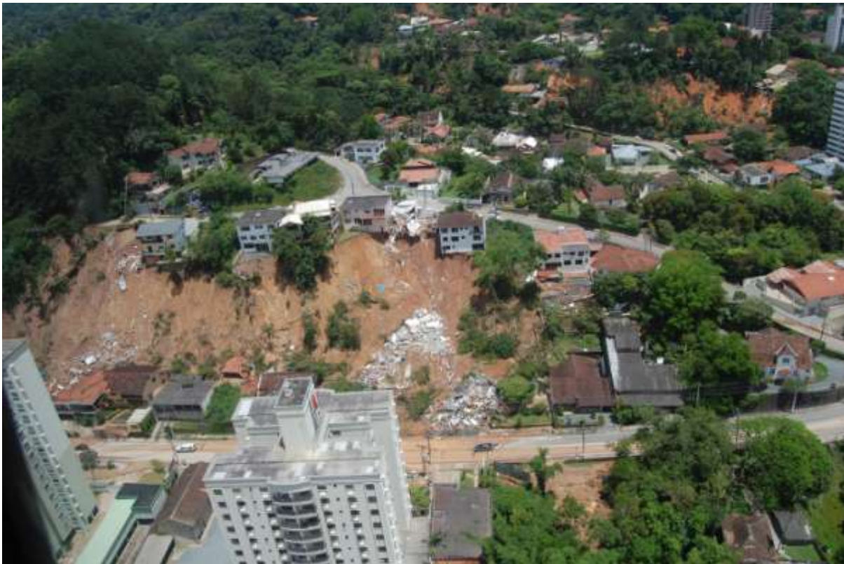
Figura 4: Deslizamento em área de risco ocupada (APP de encosta com mais de 45°) em Blumenau-SC. Observa-se a associação de ocupação de encosta com alta declividade e cortes feitos para construção de estradas e moradias. (Foto: Fabio Fáraco – 30.11.2008)
