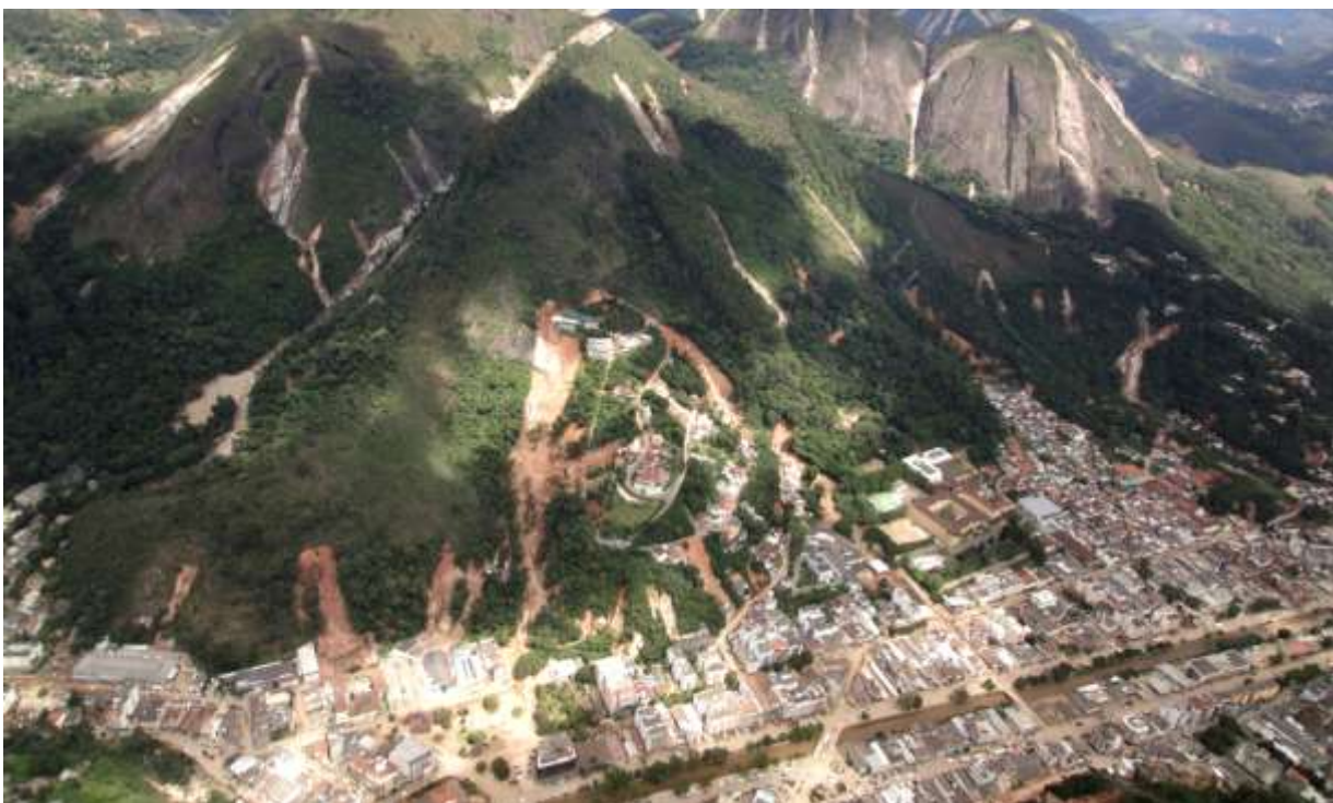
Figura 86: Nova Friburgo. Foto aérea (26.01.2011) da mesma área. Podem-se observar deslizamentos na encosta ocupada, e a lateral do rio (canalizado) totalmente ocupada por edificações, as quais foram afetadas pela inundação. Foram também afetadas as edificações construídas próximo ao sopé da montanha. Mais ao fundo observa-se deslizamentos de rochas e terra provenientes do topo dos morros e montanhas, evidenciando o grau de risco para as ocupações das encostas e aquelas localizadas no sopé dos respectivos morros e montanhas.
