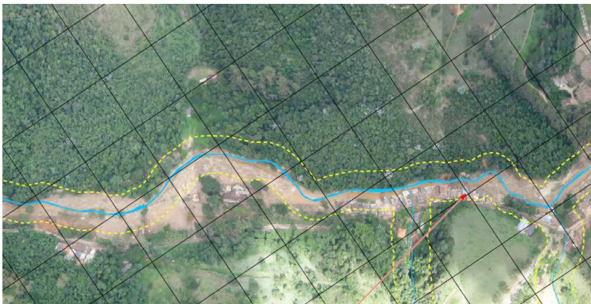
Figura 47: Foto aérea (26.01.2011) onde podem ser observados os efeitos da inundação sobre as habitações localizadas na margem do rio. A maioria das edificações afetadas encontra-se total ou parcialmente dentro da faixa de APP de 30 metros. Nota-se também que na margem oposta, no trecho onde a vegetação estava preservada os efeitos da inundação são menores, e, o que é mais importante, não houve prejuízos socioeconômicos e perda de vidas.
