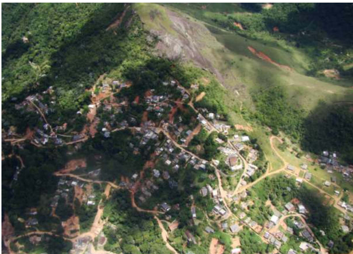
Figura 43: Bairro Granja Florestal, Teresópolis. Foto aérea (26.01.2011). Notam-se diversos deslizamentos associados às estradas ou intervenções para edificações.
