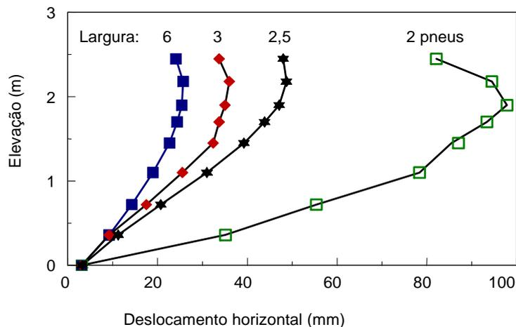
Figura 8 - Variação dos deslocamentos em função da largura do muro de pneus.
