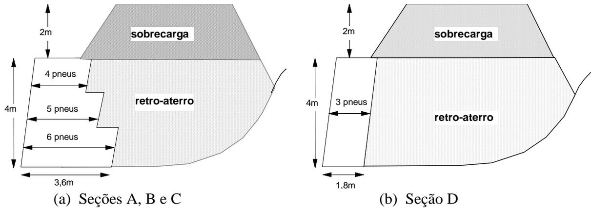
Figura 1 - Seções transversais típicas do muro experimental.
