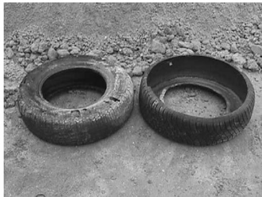
Figura 2 – Pneu inteiro e cortado
