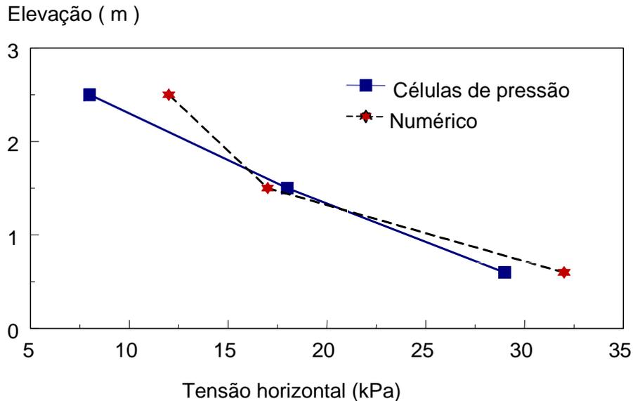
Figura 6 - Tensões horizontais: medidas e previstas (Final de Construção)
