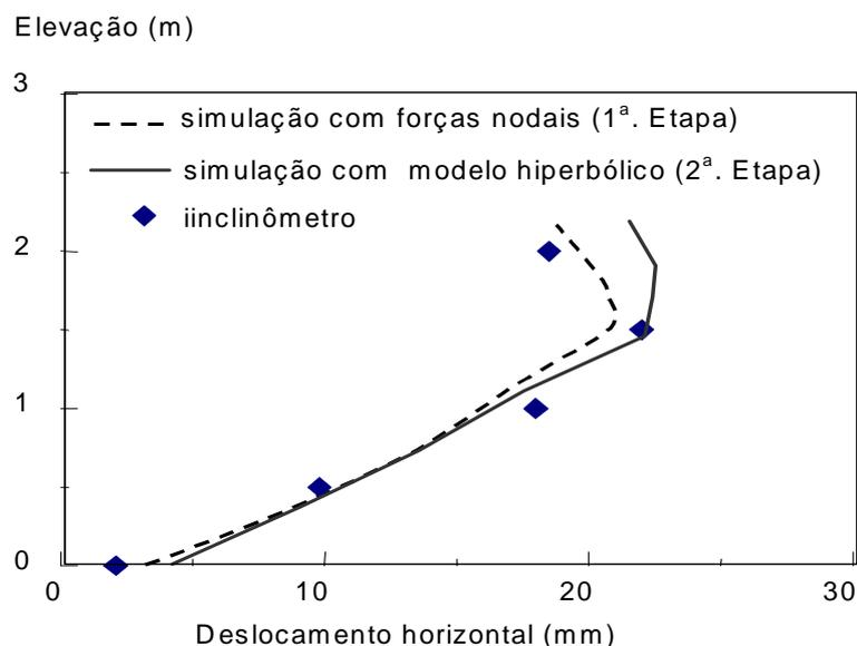
Figura 5 – Deslocamentos horizontais: medidos e previstos
